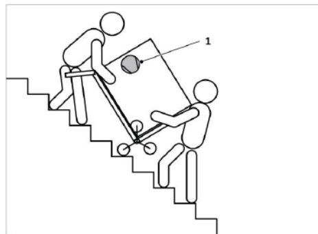
Obr. 3 Přeprava po schodech pomocí schodišťového vozíku
